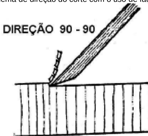
Figura 81 - Esquema de direção do corte com o uso de facão.
