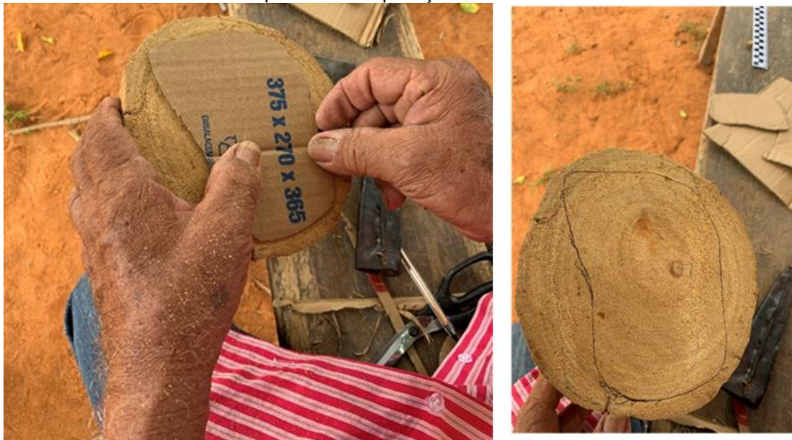
Figura 73 - À esquerda o posicionamento do molde para riscar o formato do pé- À direita o pé riscado no pedaço de umburana
