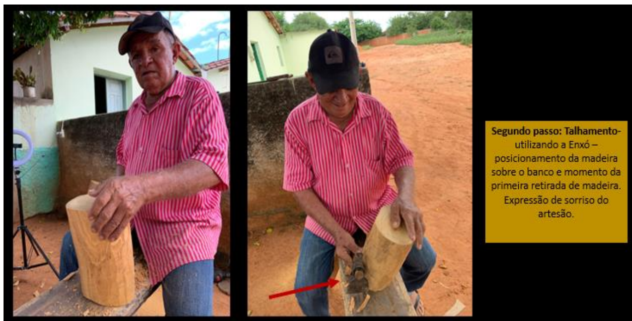
Figura 78 - Segundo passo, início do talhamento com a Enxó.
