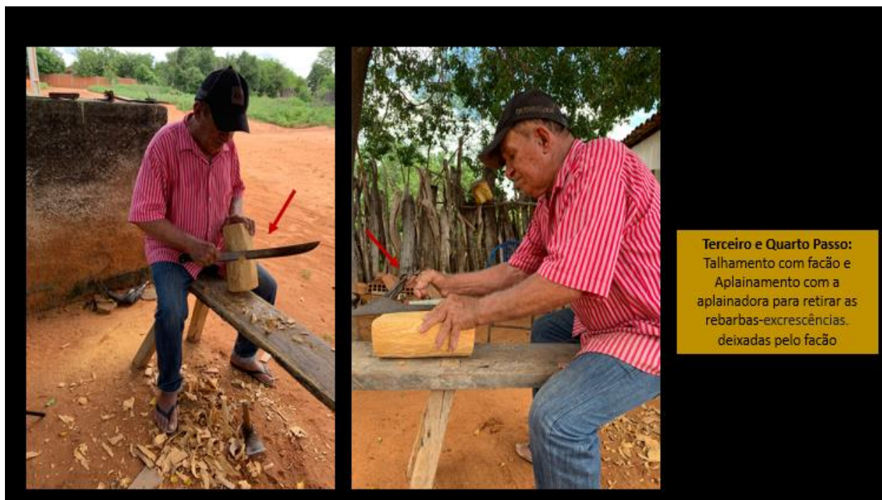
Figura 80 - Terceiro e quarto passo, continuidade do talhamento com o facão e aplainadora.
