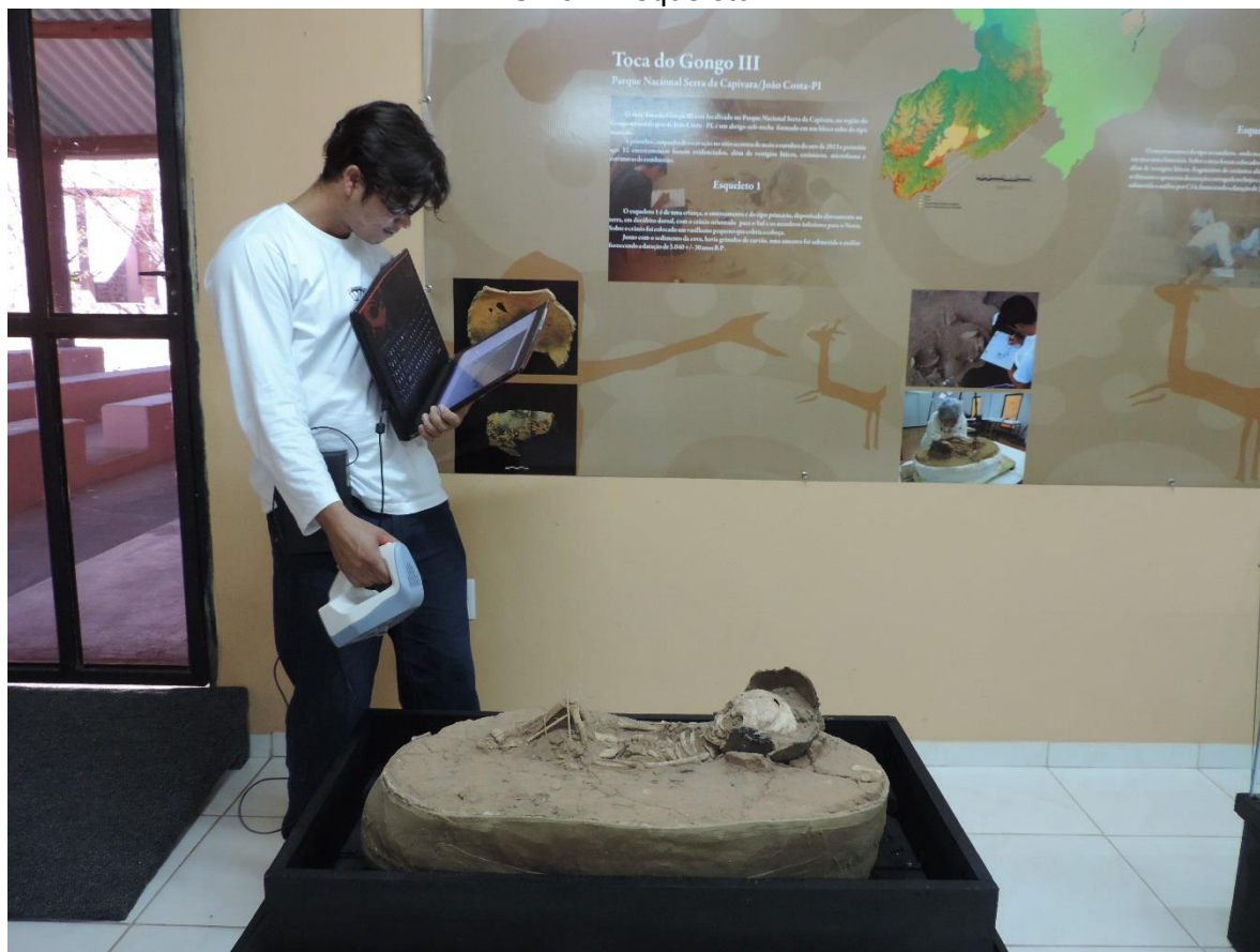
Figura 30 - Imagem ilustrando a atividade de registro tridimensional por varredura a laser. Urna 1/Esqueleto1
