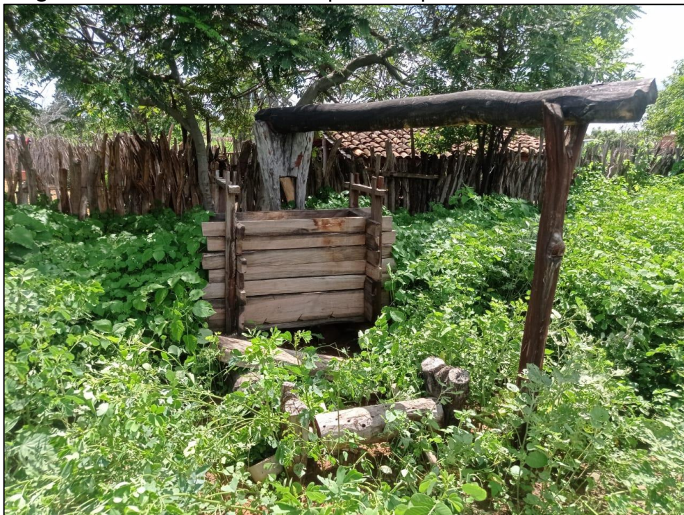
Figura 28 - Prensa de madeira para compactar a massa da farinha
