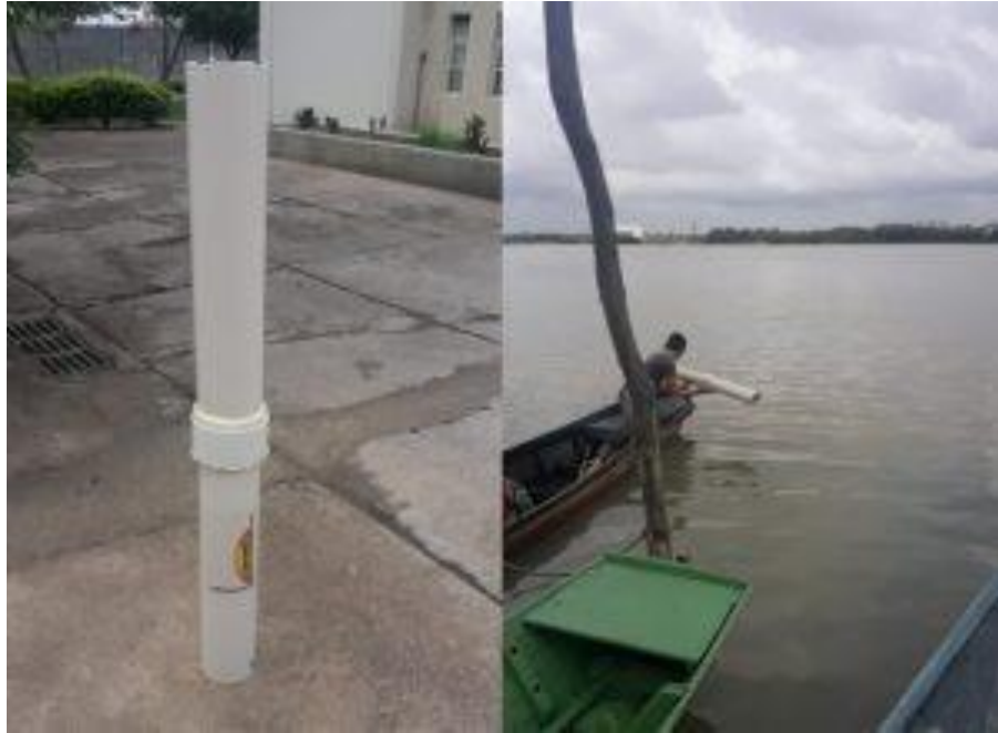
Protótipo de elemento filtrante testado no rio São Francisco
