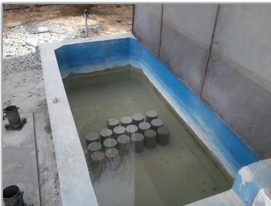
**Figura 5 - Corpos de Prova em Cura**
