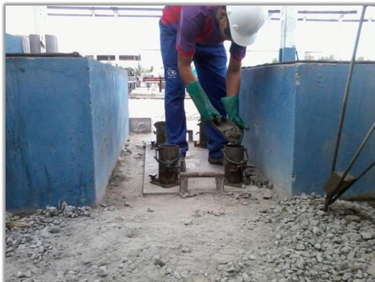
**Figura 7 - Produção do Corpo de Prova**
