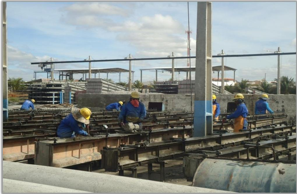
**Figura 14 - Concretagem das Formas**
