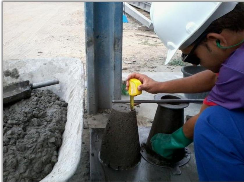
**Figura 6 - Slump Test**
