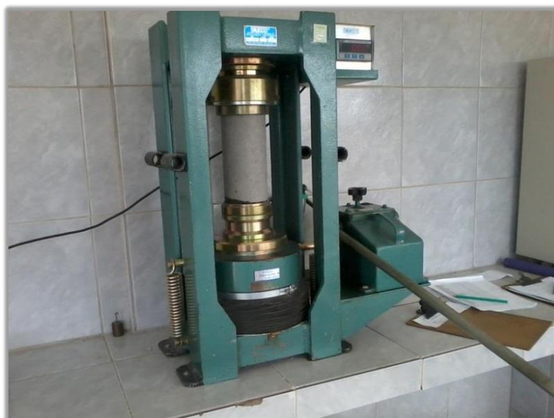
**Figura 8 - Prensa para Ruptura do Corpo de Prova**
