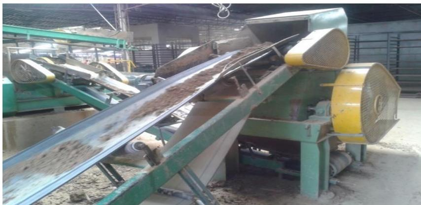
**Figura 15: Máquina de desintegração**
