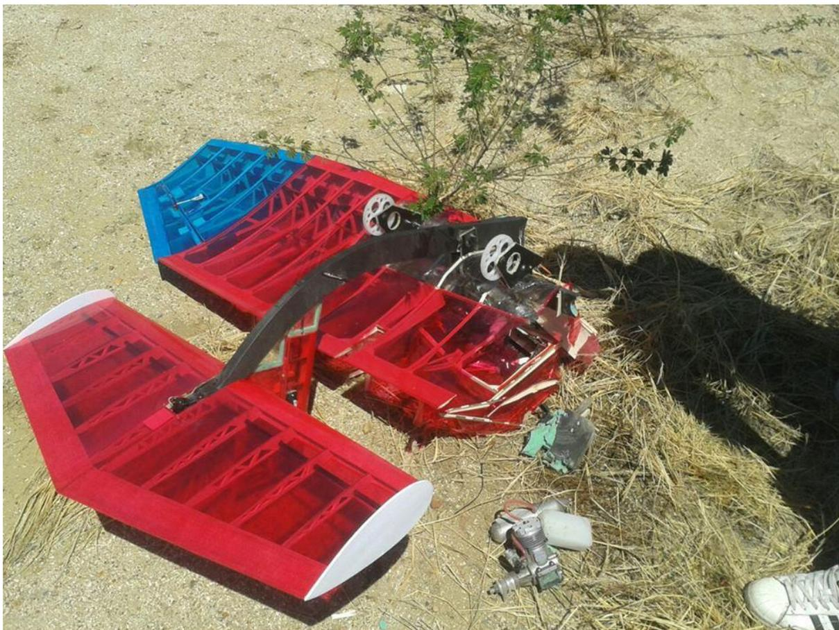
Figura 76: Aeronave oficial após queda por falha estrutural
