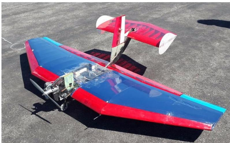
Figura 62: Aeronave AGE I após primeiro reparo, sem carenagem
