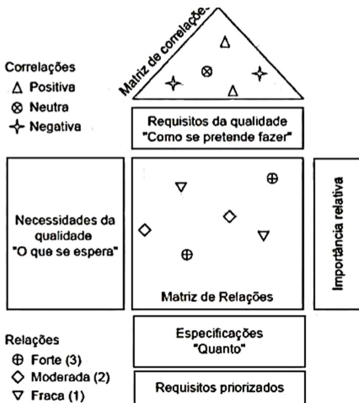
Figura 29: Representação simplificada do método QFD.
