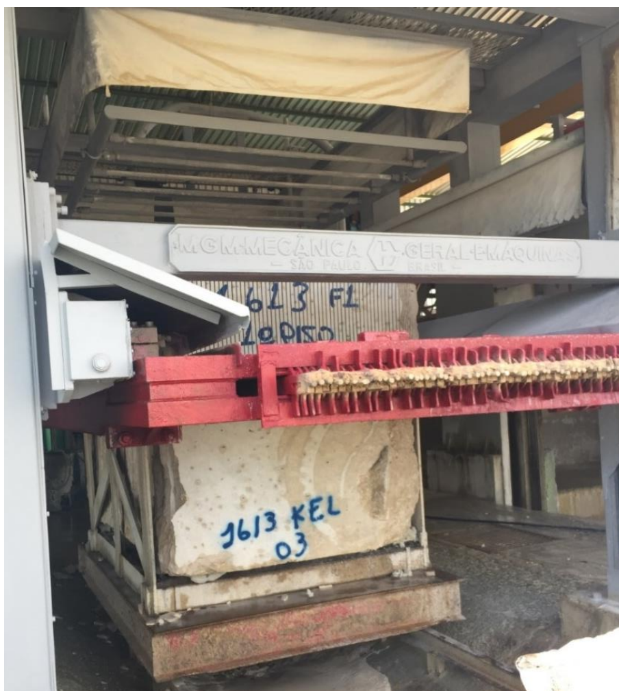
Figura 20 – Placas de mármore se formando durante o corte
