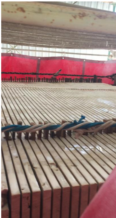
Figura 21 – Solução para prevenção de envergamento de placas durante o corte
