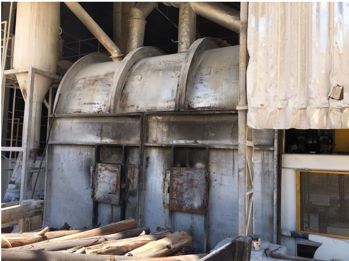
Figura 10: Forno utilizado para calcinação
