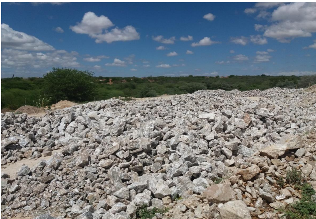
Figura 8: Gipsita utilizada no processo fabril local
