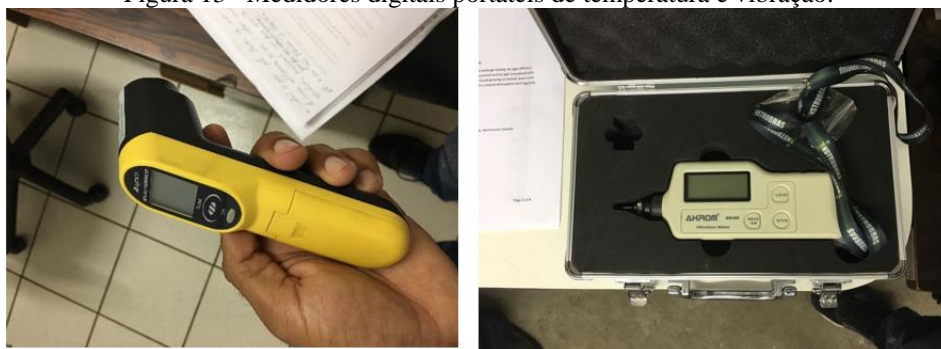
Figura 13 –Medidores digitais portáteis de temperatura e vibração.
