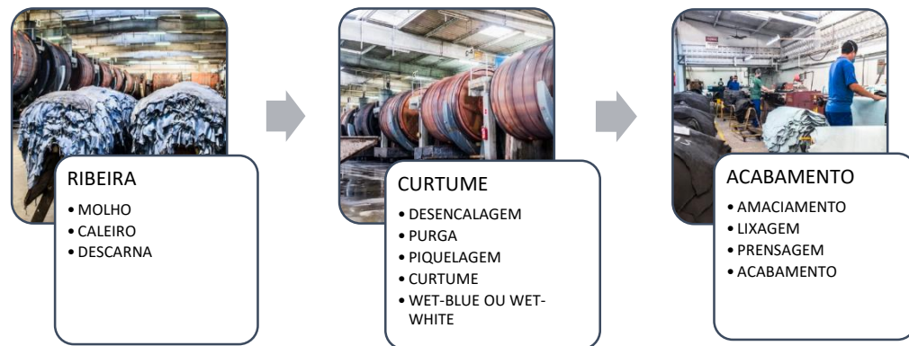
Figura 4 – Fluxograma das principais etapas do processo de fabricação do couro
