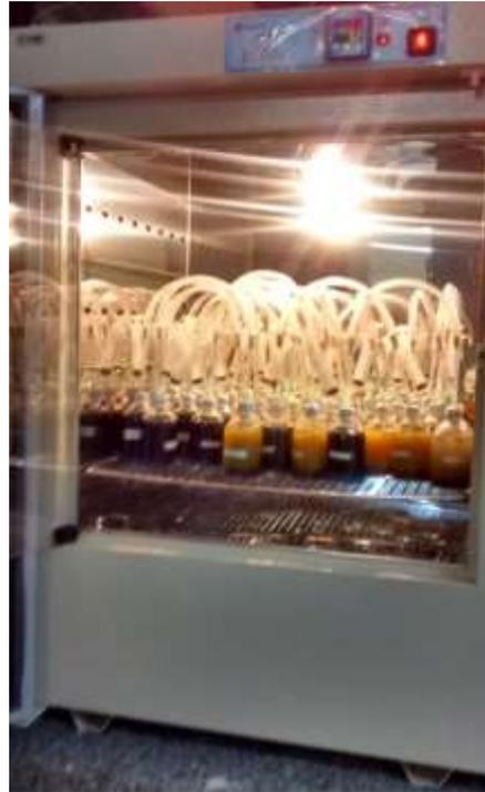
Os ensaios tiveram duração de 192 h, com medições diárias da produção de metano, análise de demanda química de oxigênio (DQO), ácidos graxos voláteis (AGV), alcalinidade total (AT) e pH em intervalos de 24, 48, 96, 144 e 192 h após montagem completa e lacre dos frascos (dia zero), conforme tabela 2.
