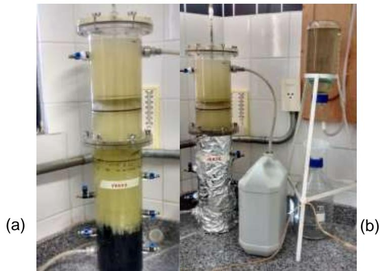
A operação propriamente dita do reator foi realizada em três etapas: aclimação da biomassa ao efluente a ser tratado (etapa I), seguida pela partida (etapa II) e posterior operação (etapa III).
