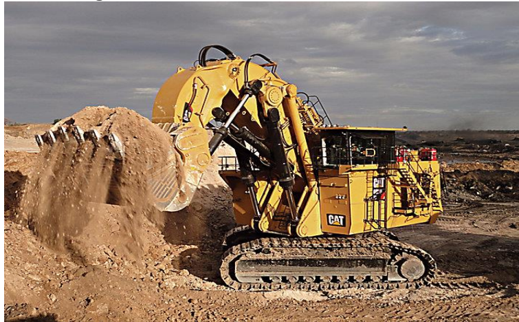
Figura 9: Escavadeira hidráulica Shovel 6090
