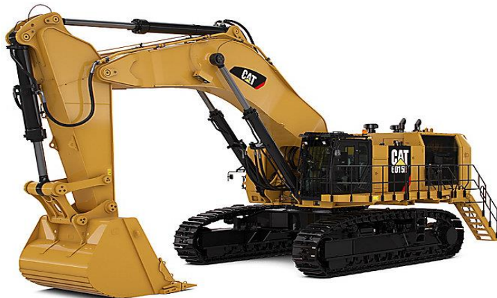
Figura 10: Escavadeira Hidráulica caterpillar 6015B
