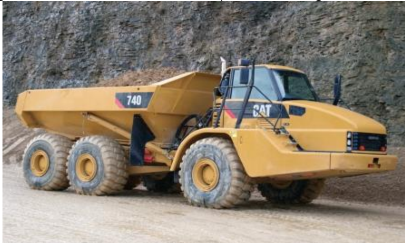
Figura 13: Caminhão articulado com capacidade de carga de 43 toneladas
