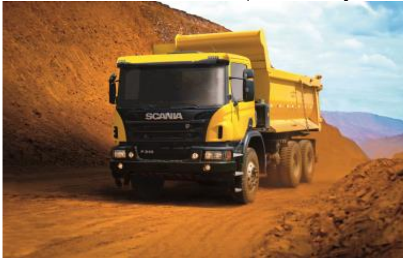
Figura 12: Caminhão basculante comum com capacidade de carga de 35 toneladas
