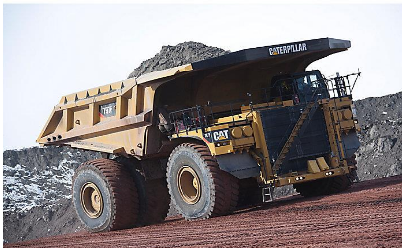
Figura 14: Caminhão “off-road” com capacidade de carga de 363 toneladas
