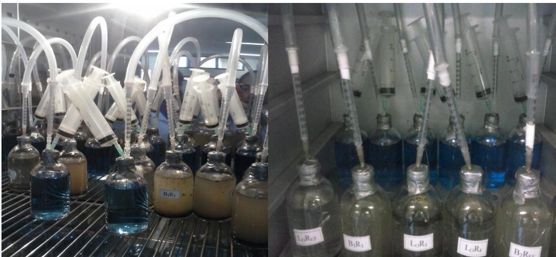
Figura 3: Frascos-reatores utilizados para a avaliação da AME
