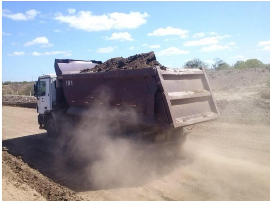
**Figura 16:** Caminhão Basculante de 35 toneladas (CB)
