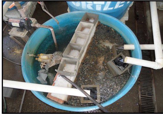
Figura 4 - Biofiltro em sistema fechado de recirculação de água.
