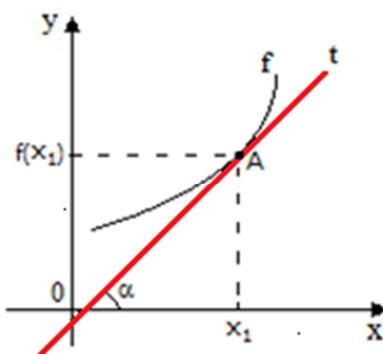
Figura 13. Inclinação da curva  $f$  no ponto  $A$ .
