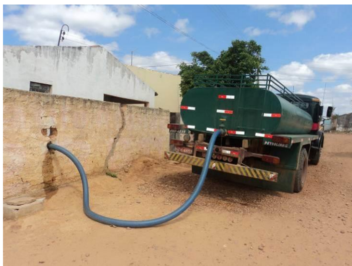
Figura 17 - Abastecimento de cisternas com água de carro-pipa
