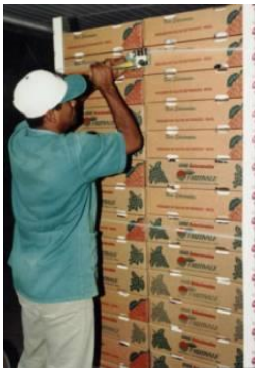
Figura 38 - Amarração de pallets .
