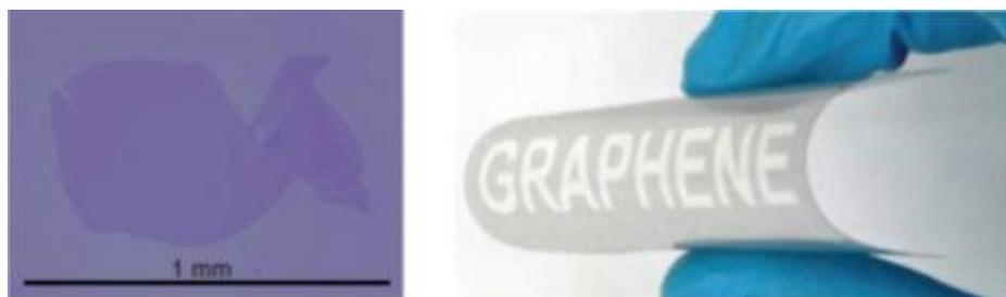
Figura 1.1.1: (a) cristal de grafeno sob uma lâmina de óxido de silício. (b) grafeno impresso em plástico [14]
