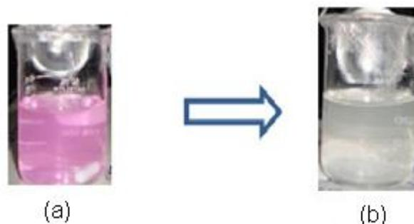
Figura 43. (a) Sistema RB/  $\text{TiO}_2$ / SDS no início da irradiação e (b) após 10 min de irradiação.
