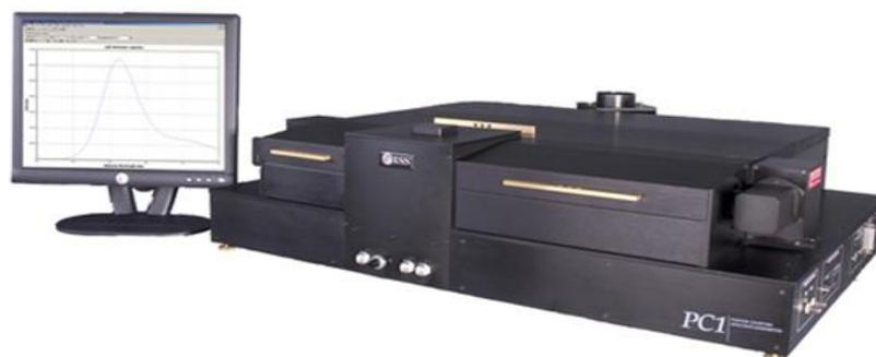
Figura 23. Espectrofluorímetro ISS PC1
