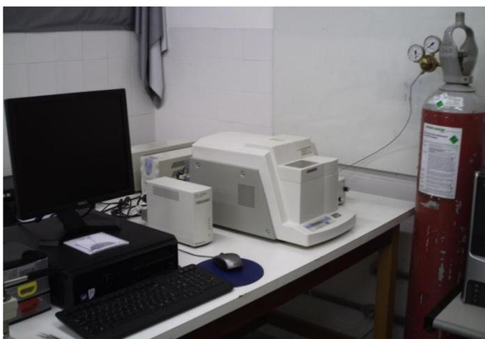
Figura 26 - Calorímetro de varredura diferencial
