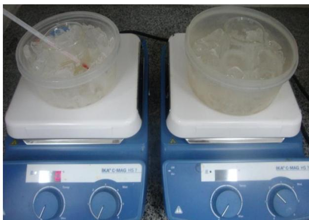
Figura 38 - Processo de resfriamento das amostras sob agitação
