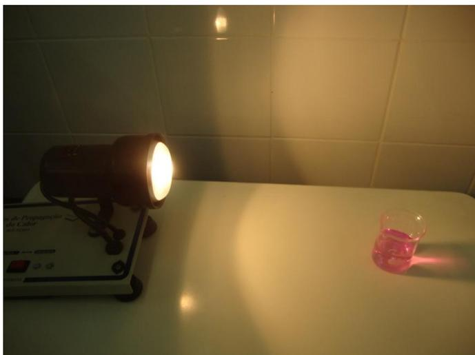
Figura 43 - Fotodegradação da Rodamina B
