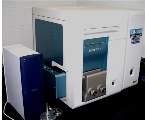
Figura 17 - Microscópio eletrônico de varredura Hitachi TM 1000
