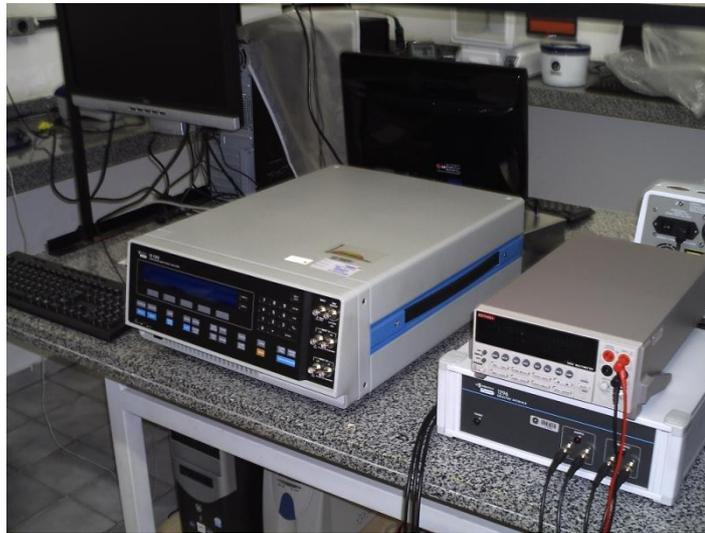
Figura 20 - Analisador de impedância Solartron 1260
