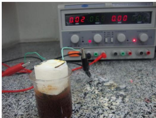
Figura 41 – Montagem utilizada na síntese eletroquímica
