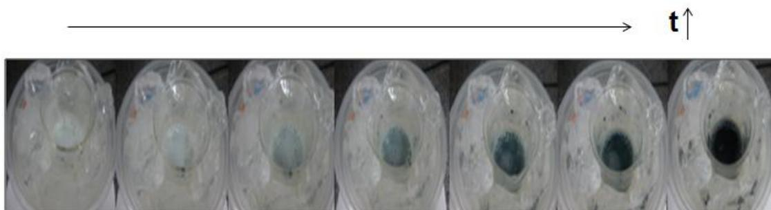
Figura 39 - Processo de polimerização do pirrol
