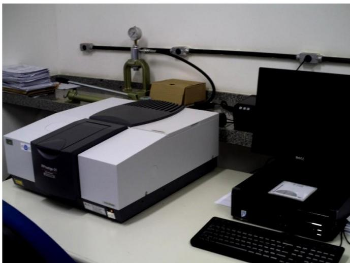
Figura 29 - Espectrômetro de Infravermelho por Transformada de Fourier Shimadzu
