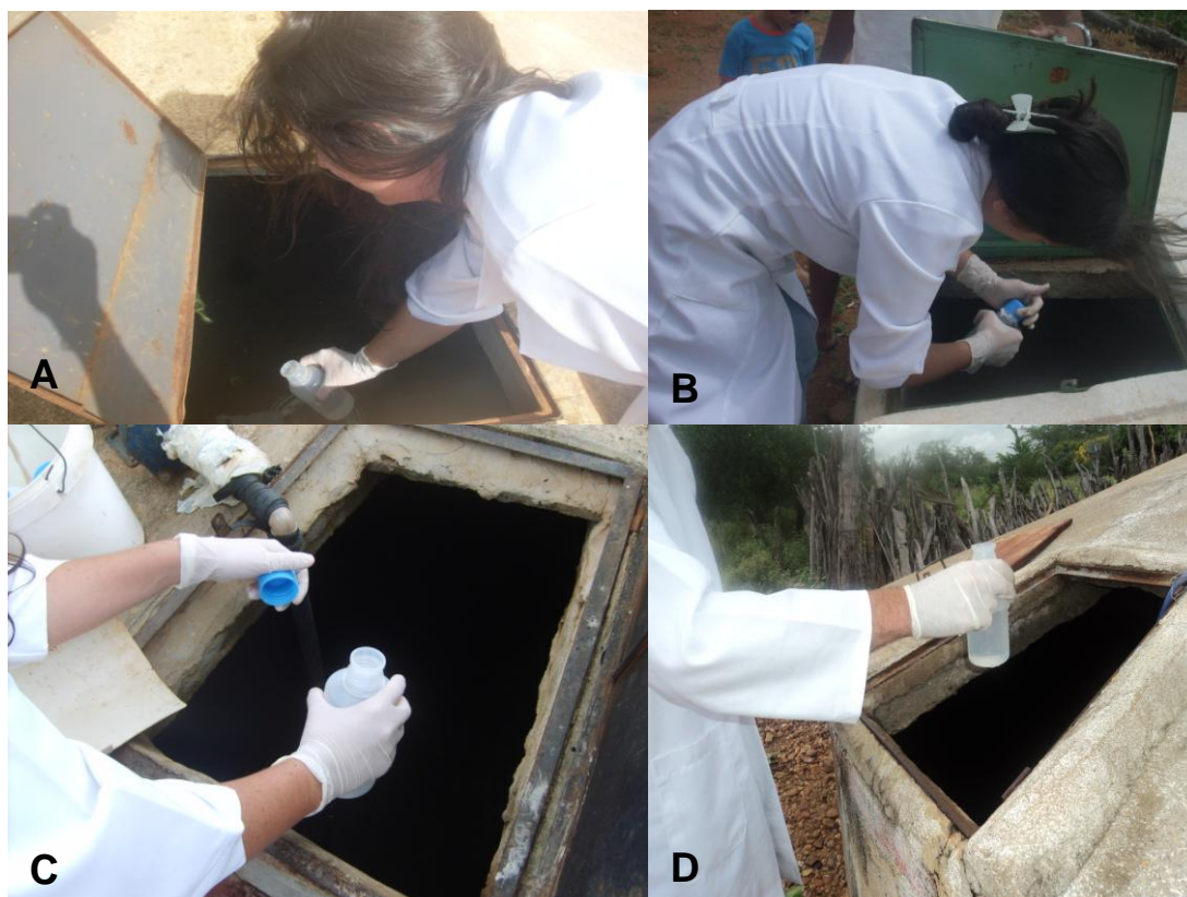
Figura 06: A, B, C e D - Coleta de amostras de água em cisternas rurais.
