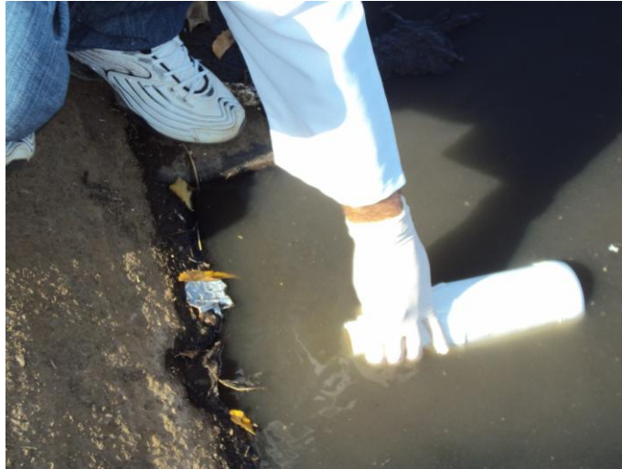
Figura 23: Coleta de esgoto na ETE.
