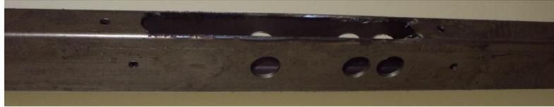
Figura 12: Metalon furado e cortado.
