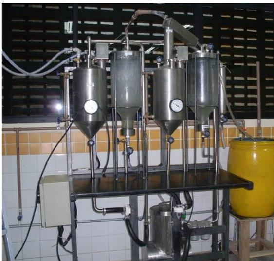
Figura 05: Mini usina para produção de até 12 Litros de biodiesel por batelada. Da esquerda para a direita: reator, decantador, tanque de lavagem/secagem e tanque de armazenamento do biodiesel. Fonte: Santos (2009.b).
