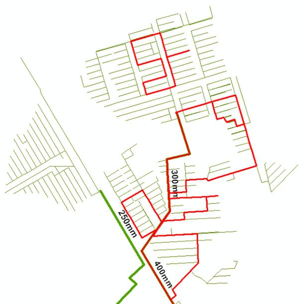
Figura 25: Trecho ampliado da área que contém Loops.
