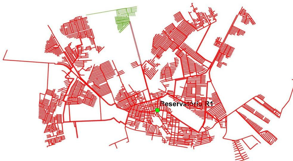
Figura 19: Identificação do trecho que está desconectado do Reservatório R1.
