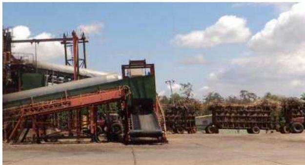
**Figura 9** – Descarga da cana nas mesas de alimentação.
