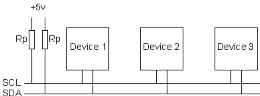
O número de “nós” em um único barramento é limitado tanto pelo tamanho do endereço, que pode ser de 7 bits, 10 bits e até 16 bits; como por restrição de espaço, já que não se pode ultrapassar poucos metros de fios, pois a capacitância total máxima, algo em torno de 400pf, impede o funcionamento correto do barramento.
