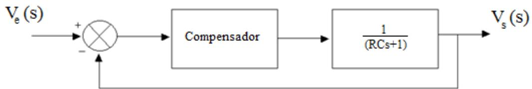
Figura 11: Equivalente em diagrama de blocos.
