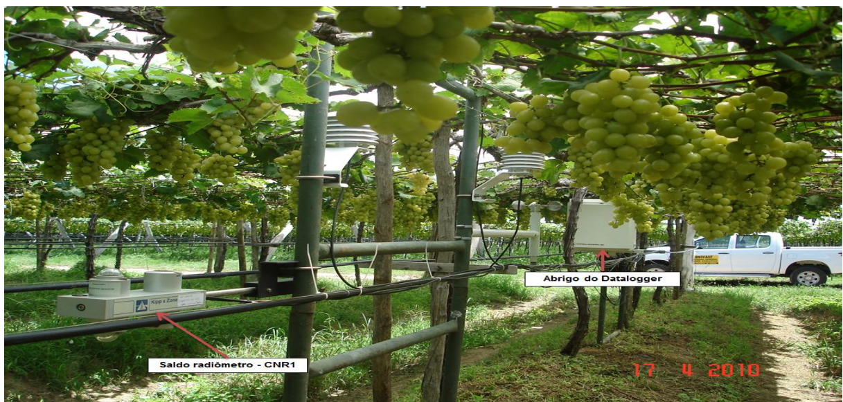
Figura 5. Saldo radiômetro CNR1 conectado a sistema automático de aquisição de dados – datalogger, Petrolina/PE, 2010.
