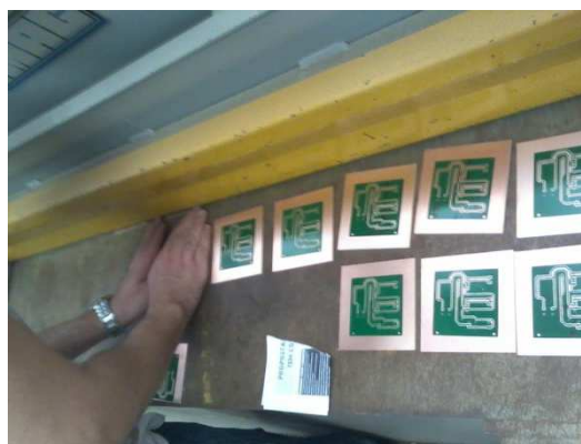
(b) impressão do circuito nas placas de fenolite através do processo de serigrafia e postas para secar, antes de serem submergidas no percloro de ferro para a corrosão das partes expostas
