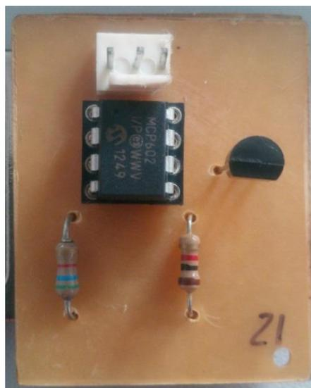
Figura 4. Mini data logger com sensor de temperatura para registrar os dados da temperatura interna das colmeias desse estudo durante as 24 horas.
