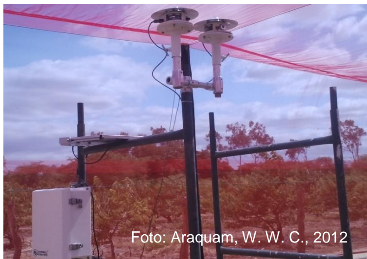
Figura 05. Piranômetros espectrais utilizados para medir a transmitância da radiação pelas telas.
