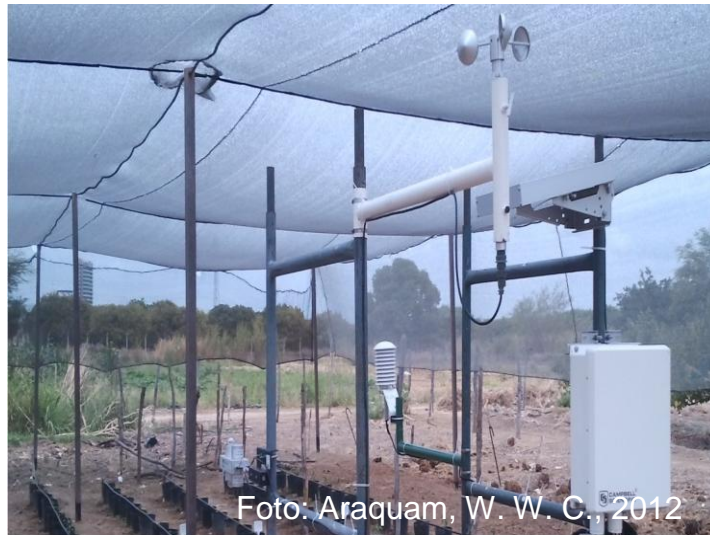
Figura 03. Sistema de aquisição de dados Micrologger e sensores de temperatura do ar, umidade relativa do ar e velocidade do vento.
