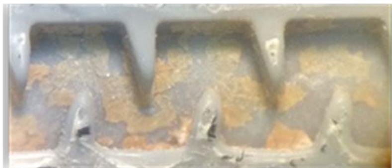
**Figura 4.** Descrição detalhada do modelo de gotejador submetido a fertirrigação na cultura do melão e uva, após 1.272 horas de funcionamento do sistema de irrigação, Juazeiro-BA, 2015.
