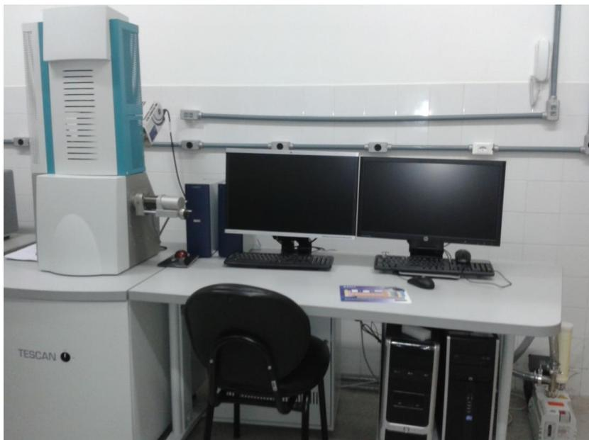
Figura 18 - Microscópio Eletrônico de Varredura, Vega 3XMU.
