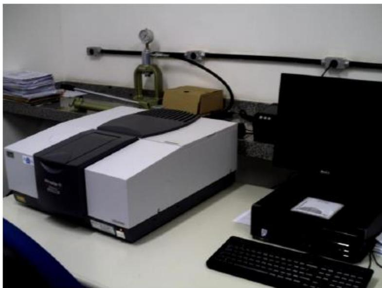
Figura 19 - Espectrômetro de Infravermelho por Transformada de Fourier Shimadzu.
