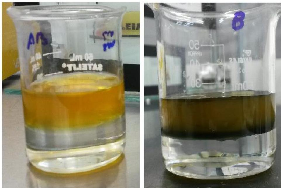
Figura 22 – Polimerização interfacial, a) fase orgânica e fase aquosa em 0h, b) formação do filme na interface após 24 h.
