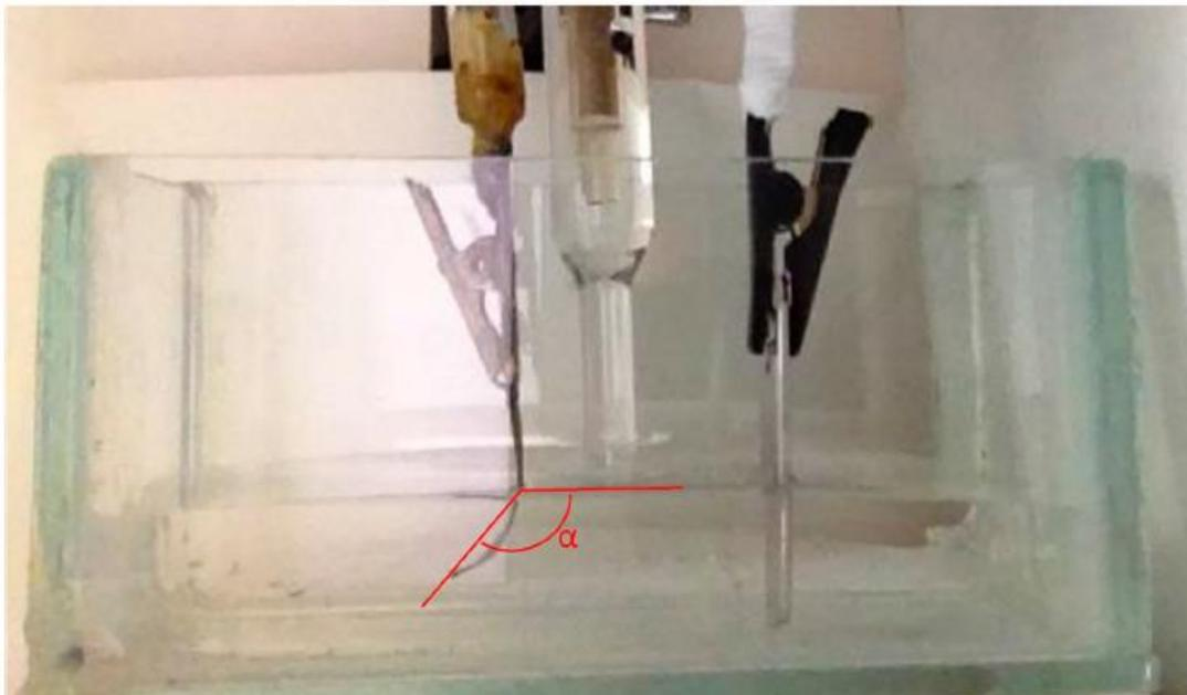
Figura 9 - Esquema de uma célula eletroquímica com configuração de eletrodos (WE eletrodo de trabalho, CE contraeletrodo e RE eletrodo referência) para obtenção de atuador com bicamada [46].
