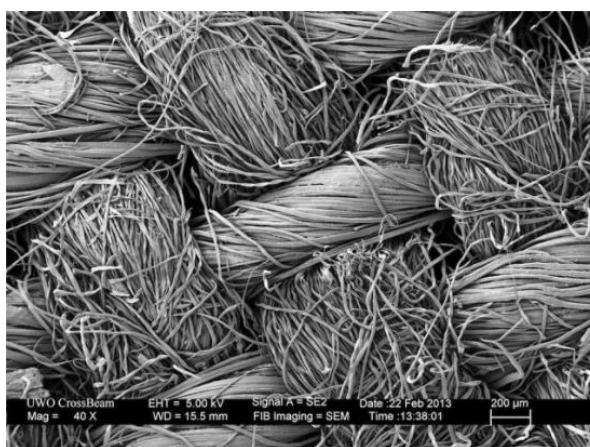
Figura 4: micrografia do entrelaçamento de tecido plano 100% algodão após desgaste (MARTIN, 2009).
