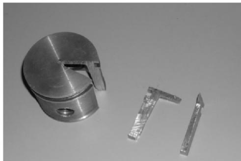
**FIGURA 2.** Foto das amostras coletadas do pistão do compressor isento de óleo.
