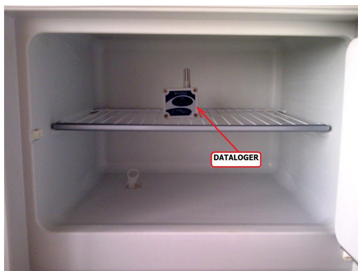
Figura 7. Foto de um Datalogger para registrar a temperatura interna do refrigerador. Fonte: Próprio autor (2009).
