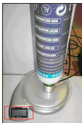
Figura 2 – Exemplo de uma carga de gás (150g / R-600a).
