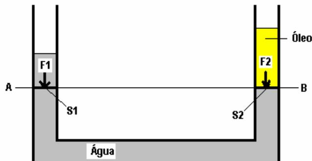
**Exemplo:** Determine a distância  $x$  na figura, considerando que o peso específico da água é  $9800 \text{ N/m}^3$  e que o peso específico do óleo é  $7350 \text{ N/m}^3$ .
