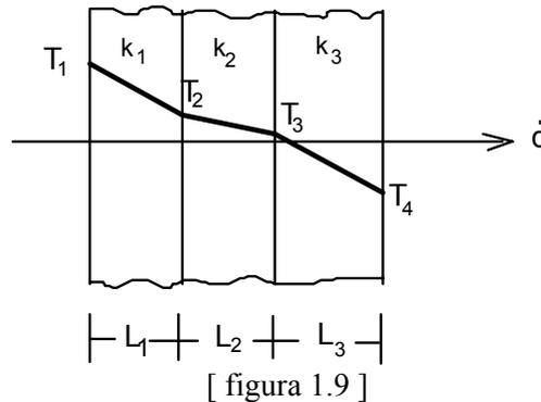
O fluxo de calor que atravessa a parede composta pode ser obtido em cada uma das paredes planas individualmente :
