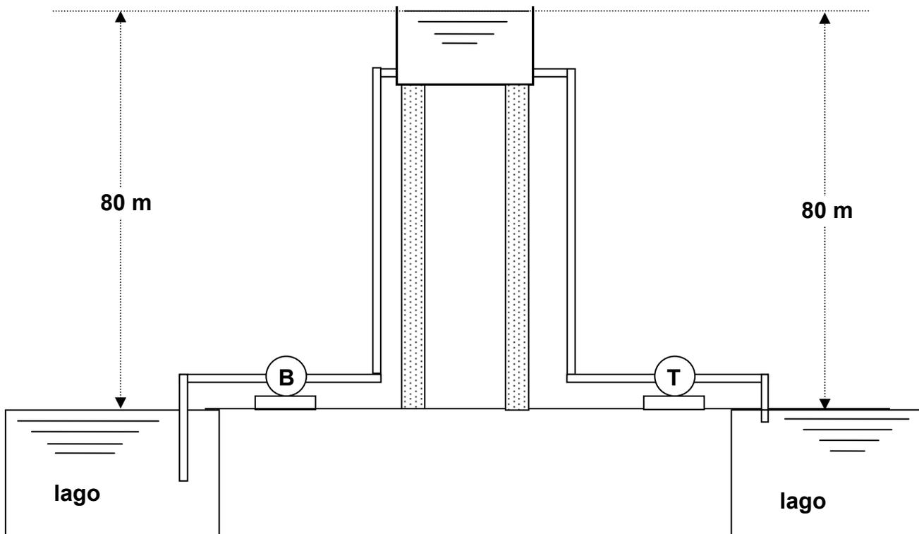
a) Tomando a seção (1) como a superfície livre do lago e a seção (2) como a superfície livre do reservatório e aplicando Bernoulli para máquina no escoamento, temos:
