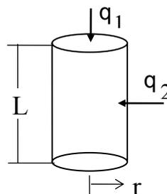
Cálculo do fluxo de calor para o copo ( desprezando a área da base ) :
