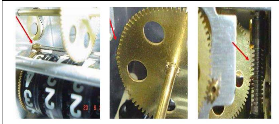
Figura 5.3 - Modificações na engrenagem de um medidor eletromecânico (Ampla, 2008).
