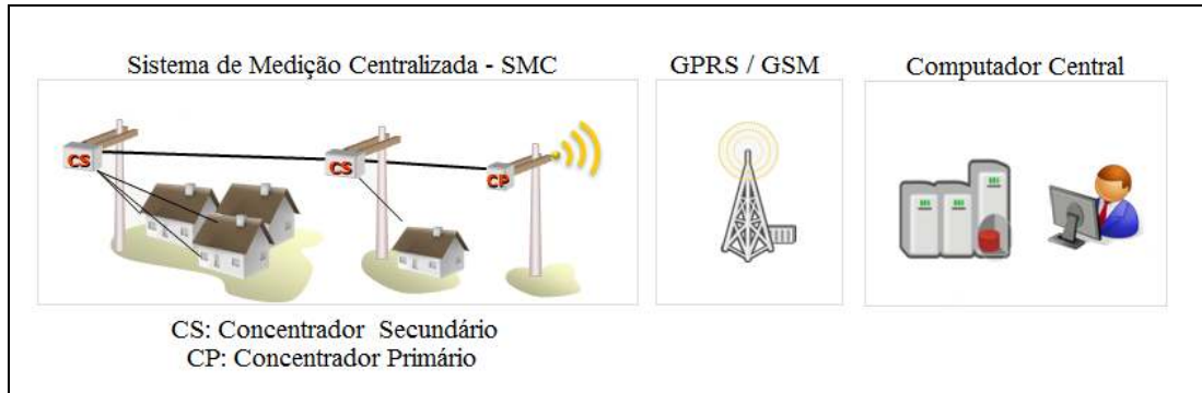
Figura 4.5 - Solução tecnológica para telemedição utilizada pela Ampla.
